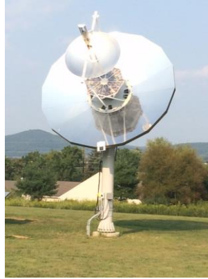
Figura 1 Tecnología de concentración solar de doble disco.
