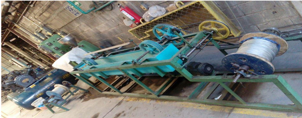
Figura 1. Proceso de forrado de cable
