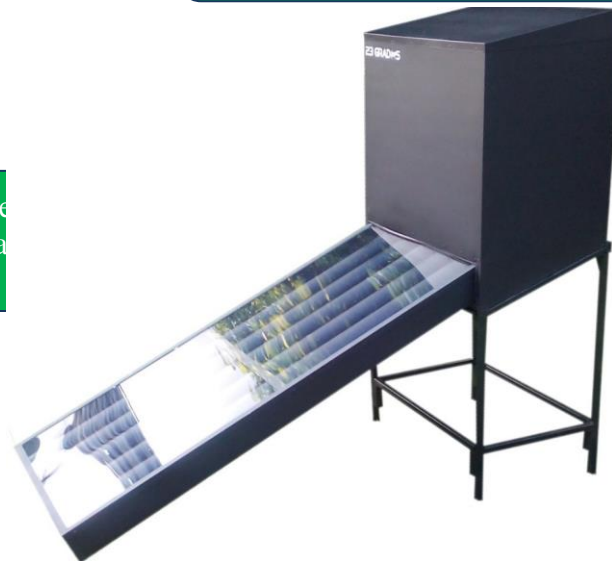
Fig. 1. Metodología deshidratador solar.
