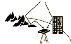
Figura 4 Interferencia por obstáculos en la superficie terrestre.
