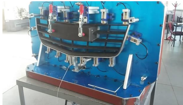
Figura 8. Prototipo físico del Checking Fixture.
