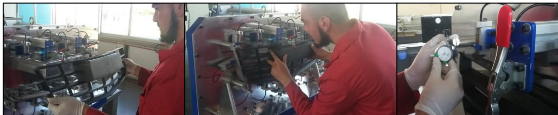
Figura 4. Procedimiento de colocación y medición en el Checking Fixture
