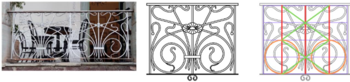
Imagen 5. (2023). Detalle del diseño armónico de la herrería del pórtico ubicado en la fachada principal.
