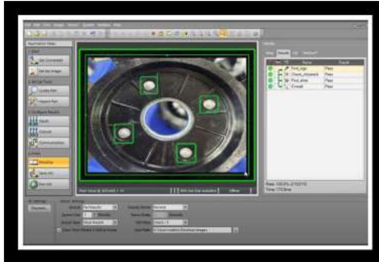
Figura 4. Detección correcta de los pines en la interfaz.
