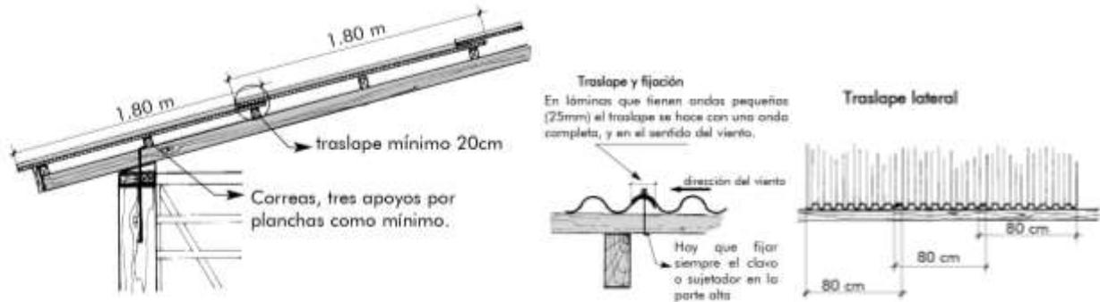
**Ilustración 10.** Detalles de traslape de cubierta de lámina.
