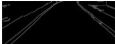
Figura 3. Imagen con la detección de bordes de Canny aplicada.
