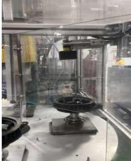
Figura 2. Cámara montada en estación de remachado.
