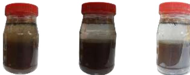
Figura 5. Prueba de sedimentación, transcurridos 10 min, 1 hora, 24 horas.
