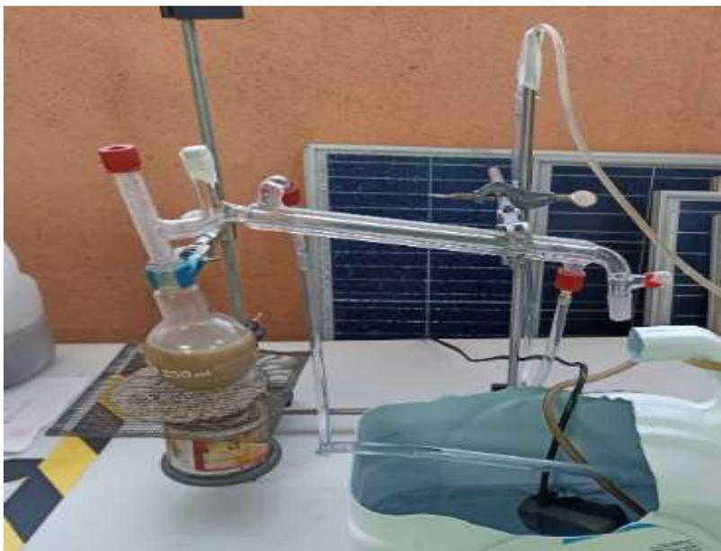
Figura 3: Diseño de mesa de trabajo para la obtención de Bioetanol
