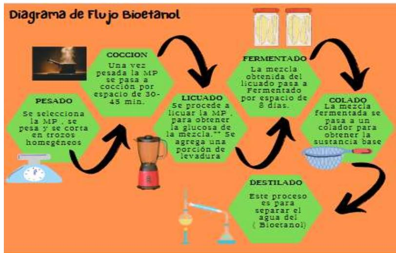
Figura 1 : Diagrama de Flujo para proceso de obtención de Bioetanol
