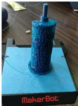
Figura 9. Impresión del tornillo helicoidal. Fuente: propia.
