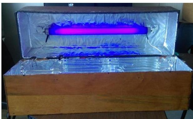
**Figura 2.** Diseño de dispositivo para degradación fotocatalítica.
