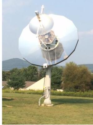
**Figura 1 Tecnología de concentración solar de doble disco.**
