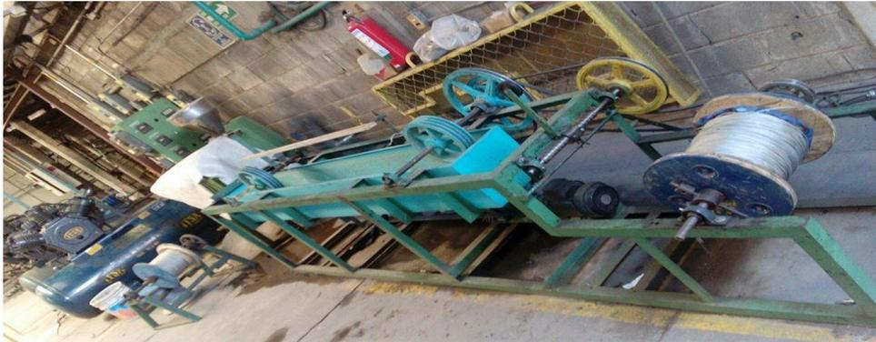
Figura 1. Proceso de forrado de cable
