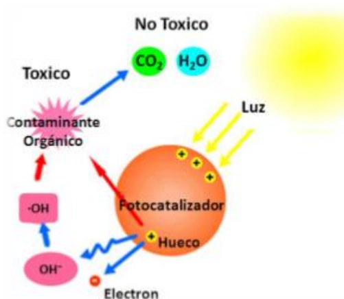
Figura 2. Diagrama de proceso de fotocatalisis.
