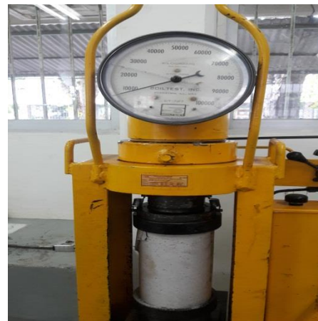
Fig. 3 Prueba de la resistencia de materiales en prensa hidráulica
