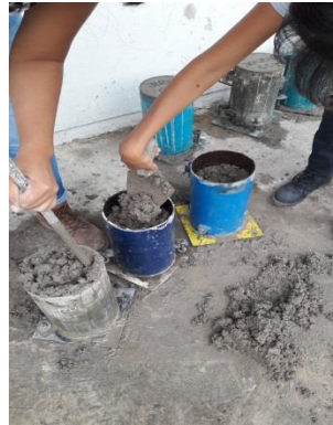
Fig.1 Vaciado de Concreto Ligero en Cilindro metálico (30 cm. longitud y 6” de diámetro)
