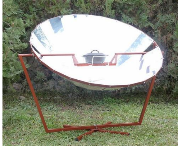
Fig.2. PhotonGrill, estufa que funciona 100 % con energía solar.
