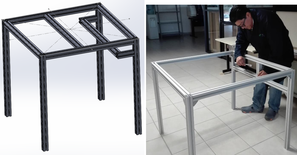
Fig. 4. Estructura del equipo y perfil BOSCH de Aluminio.
