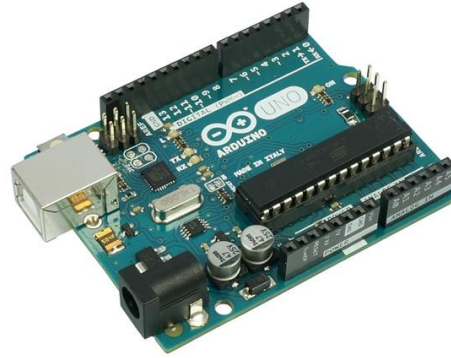
Figura 3. Placa Arduino para recepción y procesamiento de datos.
