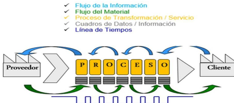
Figura 1. Componentes de un Value Stream Mapping (VSM)
