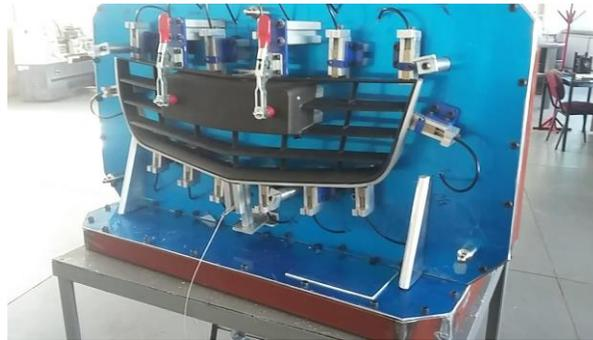
Figura 8. Prototipo físico del Checking Fixture.
