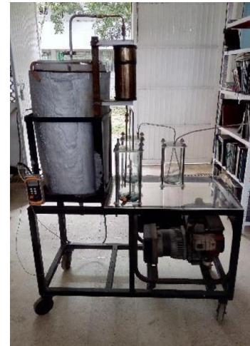
Figura 2. Prototipo horno de pirólisis para tratamiento de residuos sólidos urbanos
