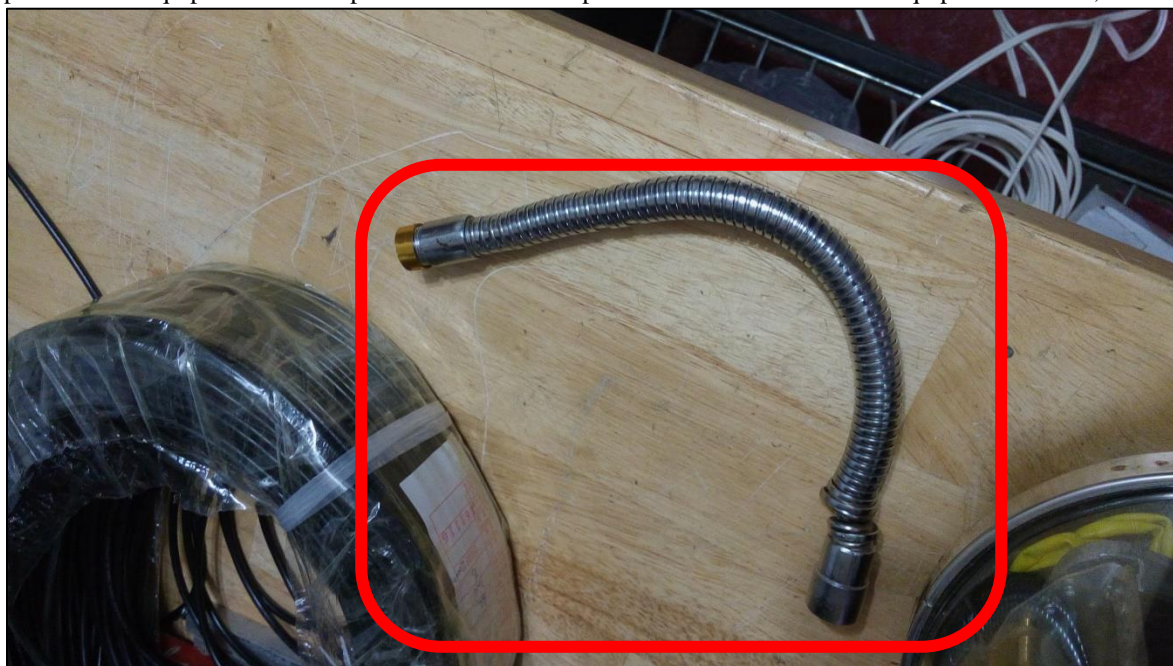
Figura 2.- Soporte utilizado para alineación del sensor dañado
