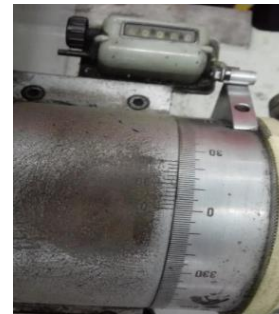
Figura 11 cuadrante de la máquina para ensayo de torsión calibrada en cero
