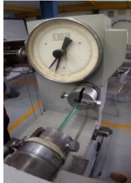
Figura 9 probeta instalada en la máquina para ensayos de torsión
