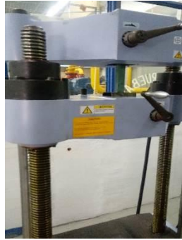
Figura1 probeta instalada en la Maquina universal de ensayos SHIMADZU
