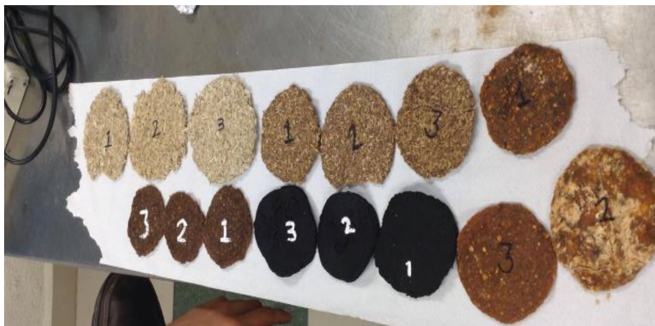
Fig. 2. Lado superior izquierdo biomaterial con fibra de maíz, centro son biomaterial con fibra de bagazo de cerveza, lado inferior izquierdo biomaterial con cascara de naranja, central biomaterial con fibra de café y lado derecho son de biomaterial con fibras de bagazo mixto de frutas y verduras.
