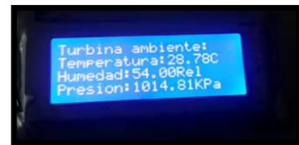
Figura 10. Muestreo de parámetros obtenidos en pantalla LCD de 20x4 ambientales.
