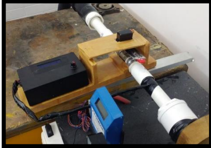
Figura 18. Acoplamiento final de válvula con motor y case de trabajo para la adquisición de datos.
