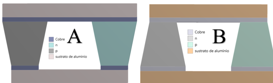
Figura 2. A) Modelo A propuesto de un TEG con dimensiones en el lado caliente de 10 mm x 10 mm y del lado frío 6 mm x 6 mm con una separación de 10 mm B) Modelo B propuesto de un TEG con dimensiones en el lado caliente de 6 mm x 6 mm y del lado frío 10 mm x 10 mm con una separación de 10 mm.
