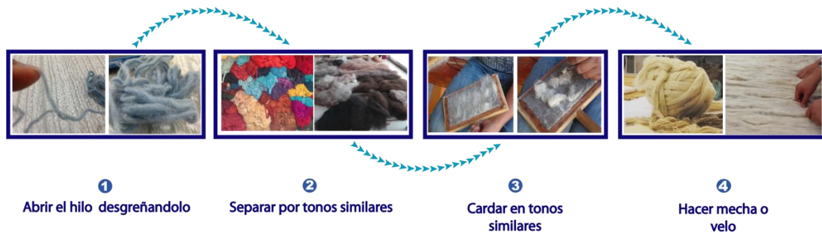
Figura 6. Proceso de reutilización de los desechos de textiles artesanales de lana. Fuente: Prodia
