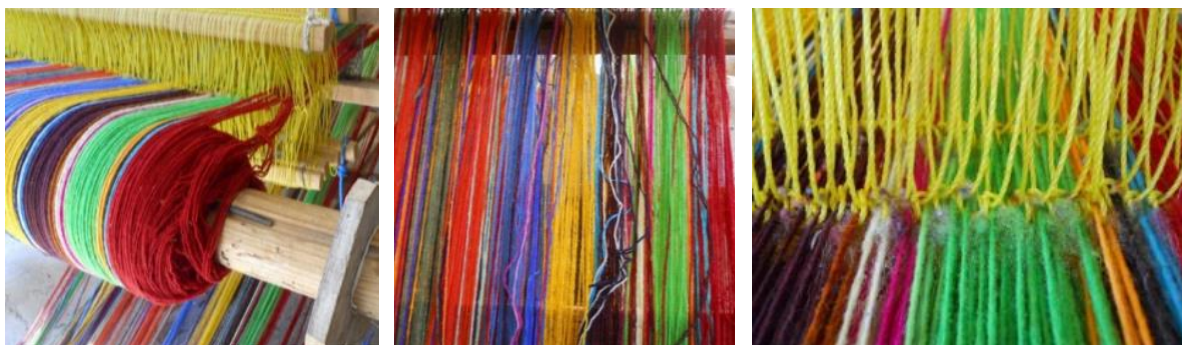
Fig. 8a. Tensión irregular en orilla Fig. 8b. Tensión irregular en centro Fig. 8c Impurezas en urdimbre
