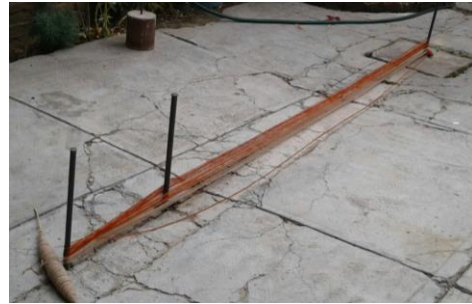
Figura 6. Descripción del proceso de urdido. Fuente: propia
