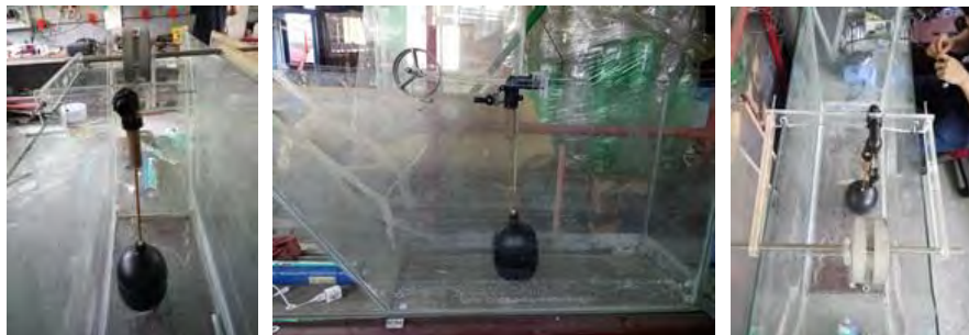
Figura 7. Ensamble de prototipo de generador mareomotriz.
