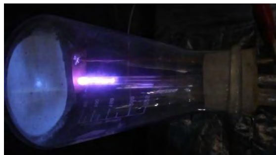
Figura 3.- Prototipo del tubo de rayos catódico en funcionamiento.
