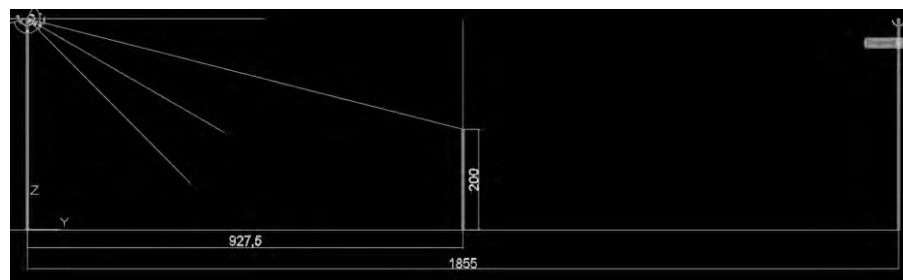
Figura 5. Longitudes promedio entre postes instalados en el perímetro de la ESIME.
