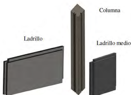
Figural. Elementos constructivos de la propuesta de Salazar Marín et al
