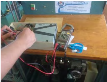
Figura 3.- Medición de continuidad de las galgas.
