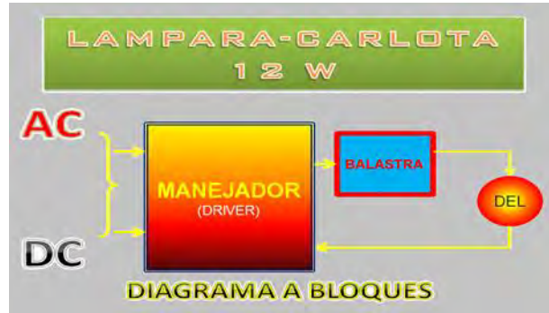
Figura 4. Diagrama a Bloques del circuito electrónico.
