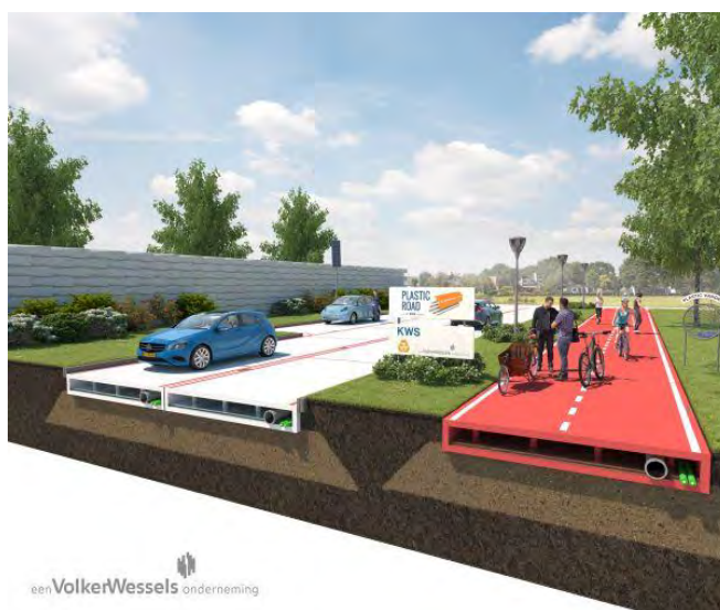
Figura 3. Propuesta de pavimento plástico de la compañía VolkerWessels
