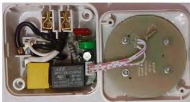
Figura 4. Aspecto interno del temporizador.
