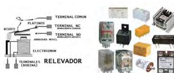
Figura 2. Tipos de relevadores y su modelo simplificado.
