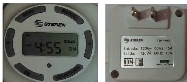
Figura 3. Aspecto del temporizador TEMP-08E de marca STEREN.
