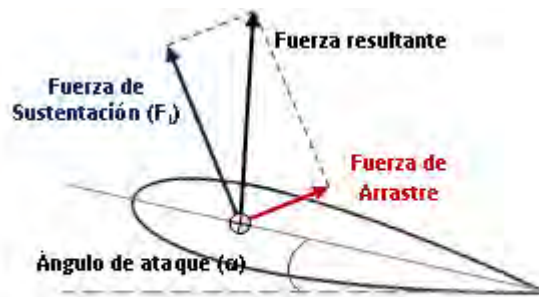
Figura 8. Fuerzas aerodinámicas actuantes sobre un perfil aerodinámico.
