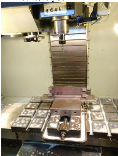
Figura 4. Manufactura de probeta con apoyo de un sistema de sujeción con manipulación para variar el ángulo de bisel y centro de maquinado CNC HAAS VM2.
