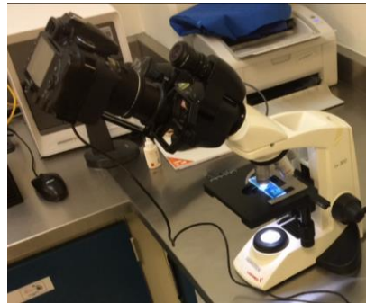
Figura 1. Sistema de toma de imágenes digitales de baciloscopias.
