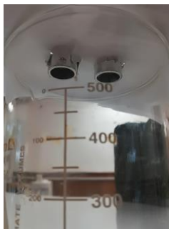
Figura 9. Sensor ultrasónico montado sobre recipiente graduado
