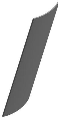
Figura 2. Alabe con curvatura sencilla (vista isométrica posterior)
