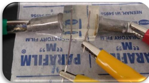
**Figura 15.** Celda electroquímica de Cloruro de potasio con grenetina.
