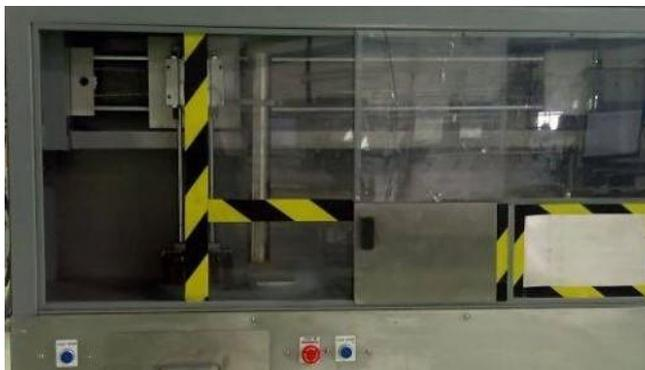
Figura 1.4 (Guarda de seguridad y paro de emergencia)
