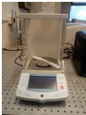
Figura 6. Pesado después de la inmersión.
