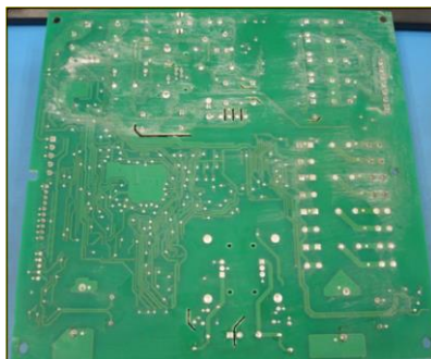
Figura 1. Residuos evidentes a simple vista de pasta fundente en circuito electrónico de modelo Copernicus.
