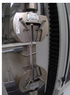
Figura 3. Máquina universal Instron
