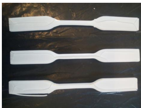
Figura 6. Probetas de PC después de 168 hr. en acetona.
