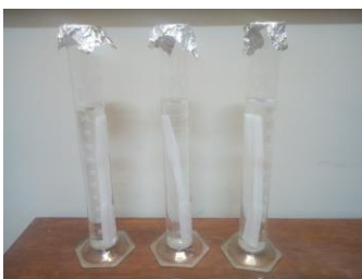
Figura 5. Inmersión de probetas en el reactivo.
