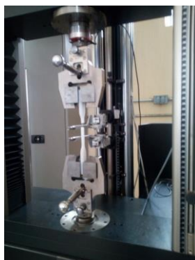
Figura 7. Ensayo de tensión.
