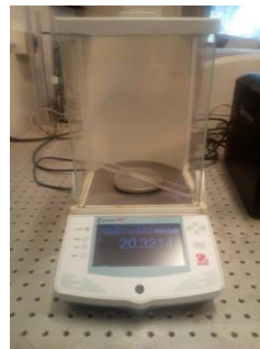
Figura 2. Pesado de las probetas.
