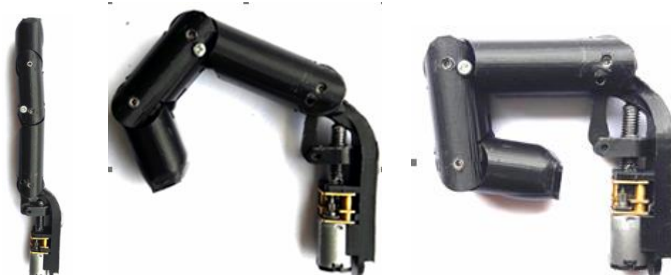
Figura 8 Dedo índice robótico multi-articulado antropométrico y antropomórfico construido en material PLA mostrando el movimiento de flexo extensión.
