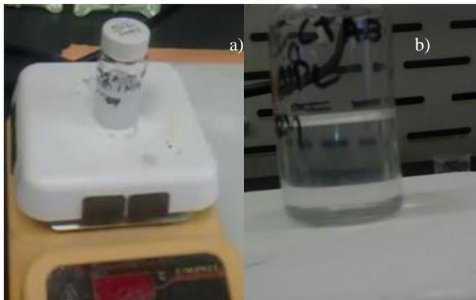
Figura 1. Soluciones de CTAB/AIPO, precipitada (a), y la adecuada para sipin coating (b).
