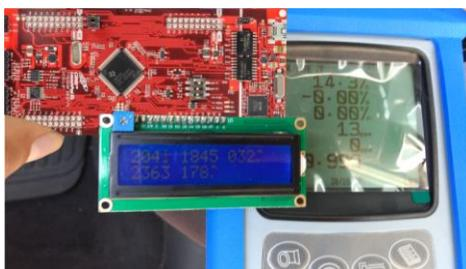
Figura 10. Comparación de la prueba emisiones de la propuesta con AUTOplus.
