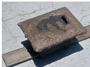
Imagen 3.2 Recipiente después del tratamiento termoquímico de cementación.
