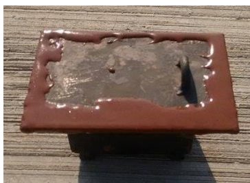
Imagen 1.2 Contenedor metálico con sellado de barro y silicio en el que se realizó la boruración.
