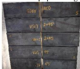
Figura 5: Biselados en las cinco probetas
