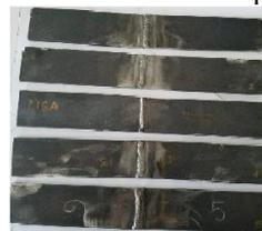
Figura 6: Probetas con diferentes biselados soldadas
