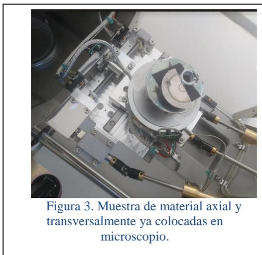
Figura 3. Muestra de material axial y transversalmente ya colocadas en microscopio.
