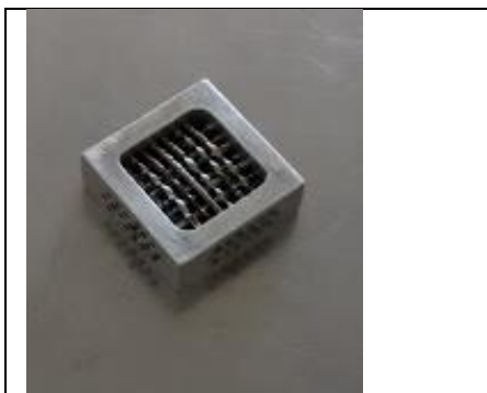
Figura 9. Celda finalizada con red de rimas de acero inoxidable
