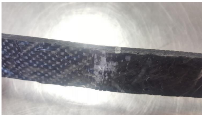
Figura 6 Fractura en probeta.
