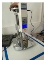
Fig. 6 Prueba de ECT
