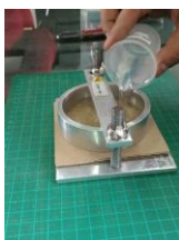
Fig.1 Prueba de Cobb
