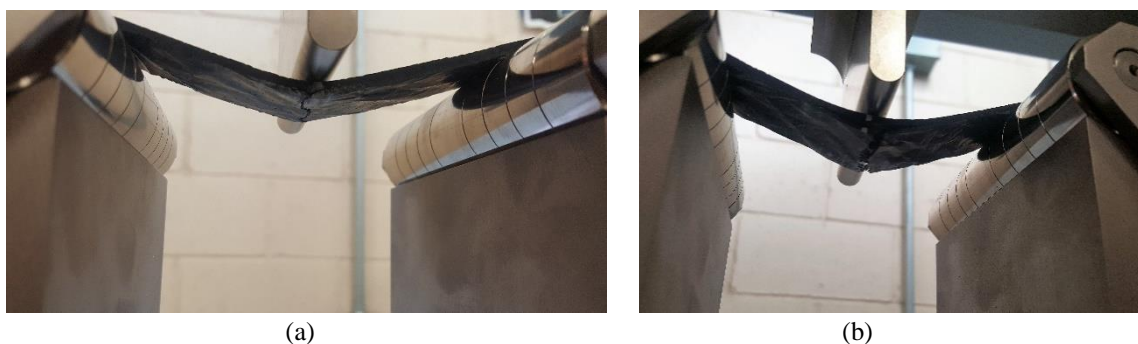
Figura 5 Delaminación en probeta (a) zona de prueba (b) acercamiento a zona de delaminación.
