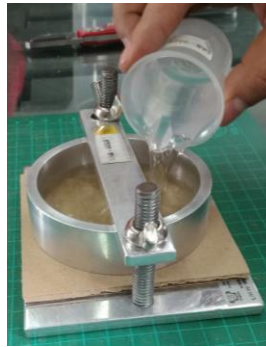
Fig 2. Absorción de humedad.
