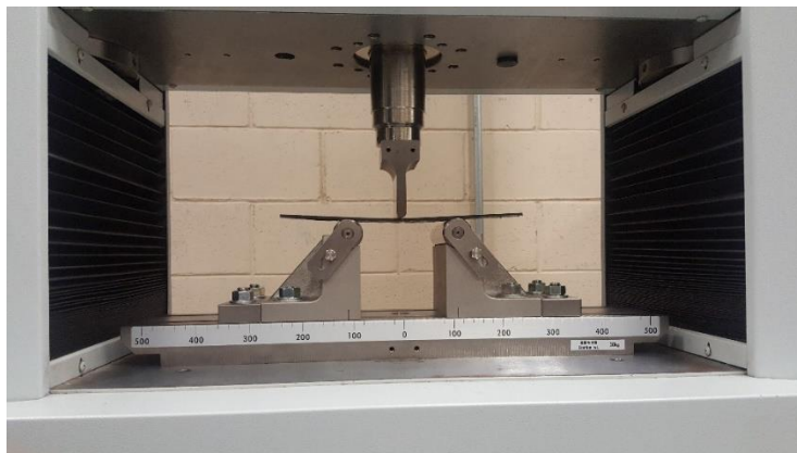
Figura 3 Probeta colocada para ensayo de flexión.
