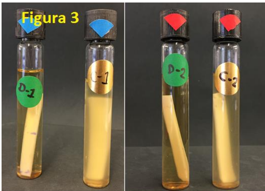
Figura 3. Verificación cualitativa del crecimiento bacteriano a las muestras de resina acrílica luego del contacto con agua desionizada y glutaraldehído en el tiempo 1 y tiempo 2 y después de la incubación con el medio de cultivo específico.
