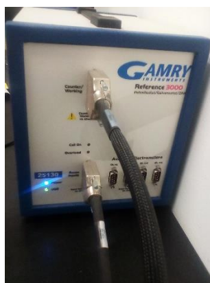
Figura 1. Potenciostato marca “Gamry instruments” modelo “reference 3000”.
