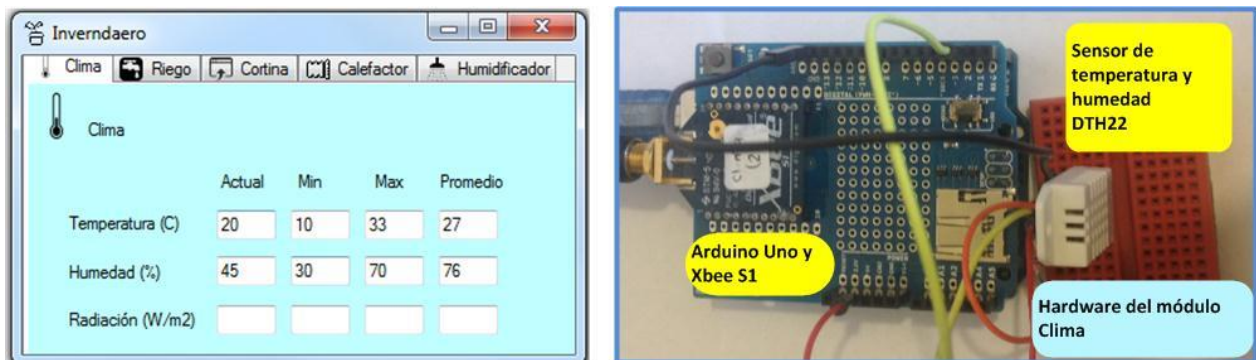
Figura 6. Software y hardware del módulo Clima
