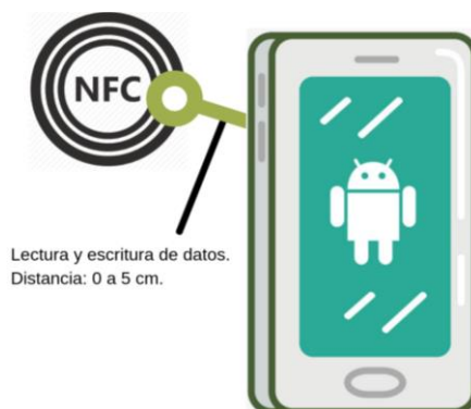
Figura 1. Interacción de dispositivo móvil y etiqueta NFC.
