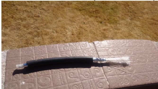
Figura 1. Diseño de cable de fibra óptica cubierto con polietileno de alta densidad.
