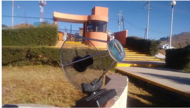
Figura 1. Prototipo para la captación y concentración de rayos solares.
