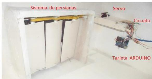
Figura 5. Interior de la casa habitación y montaje del circuito.
