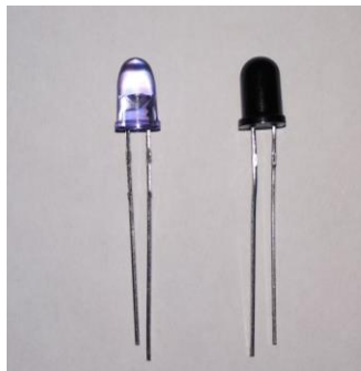
Figura 2. Led infrarrojo del lado izquierdo (emisor), fotodiodo del lado derecho (receptor).
