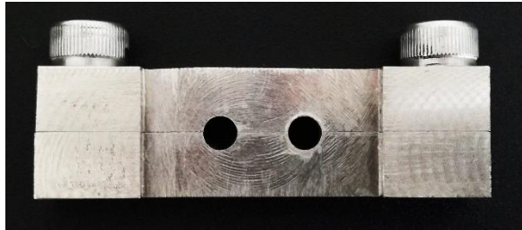
Fig 1.- Molde para elaboración de muestras para fotocurado
