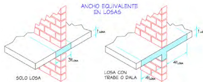
Figura 3. Anchos equivalentes de losas para estimar la rigidez a flexión.
