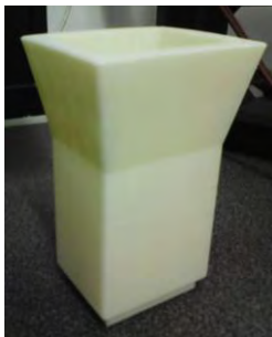
Figura 5. Tolva de almacenamiento de MP.
