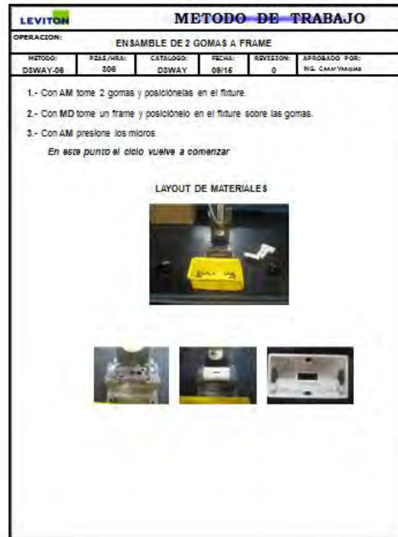
Ilustración 1 Método de trabajo del ensamble de 2 gomas a un frame
