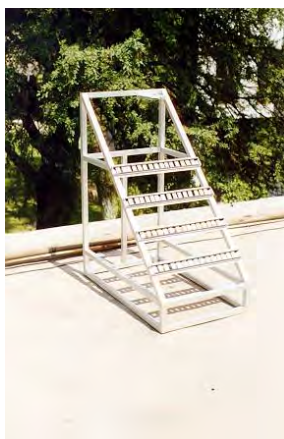
Figura 1. El pupitre está orientado hacia el sur debido a que estamos en el hemisferio norte y se obtiene la máxima exposición al sol. Fuente: Propia.
