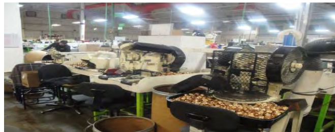
Ilustración 10 operación abrir solapas de aluminio
