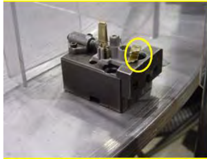
Figura 3. Defecto principal, navaja mal posicionada
