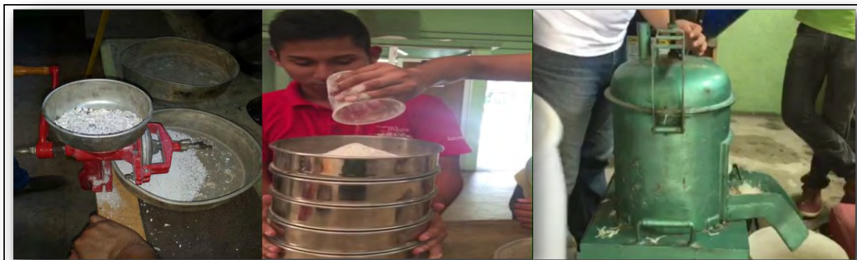
Figura 3. Foto parte izquierda triturado de la concha de ostión. Foto parte derecha máquina trituradora de pluma avícola. Foto central cribado de la concha de ostión triturada y molida.
