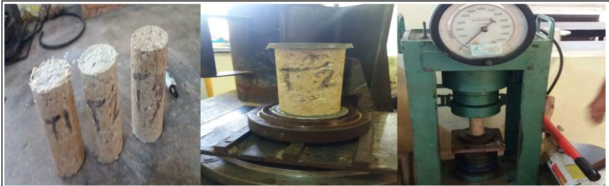
Figura 4. Fotos de prueba a la compresión de los especímenes elaborados en laboratorio, foto central corresponde al cabeceo de los especímenes y foto lado derecho corresponde a compresión del espécimen.
