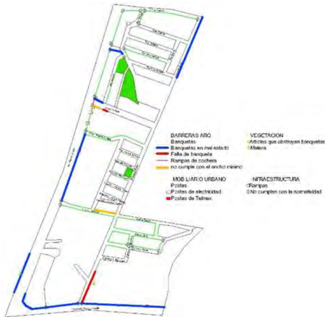
Figura 4: inventario del estado de la infraestructura, rampas para discapacitados, y barreras
