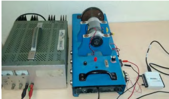
Figura 1.- Conexión de la planta a controlar con la fuente de alimentación y la tarjeta de adquisición de datos.
