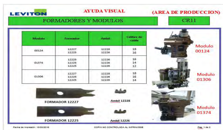
Figura 10. Ayuda visual para cada calibre de cable.
