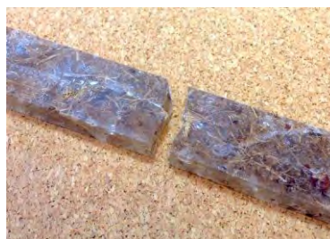
Figura 3. Detalle de fractura de las probetas de PLA + fibra de agave
