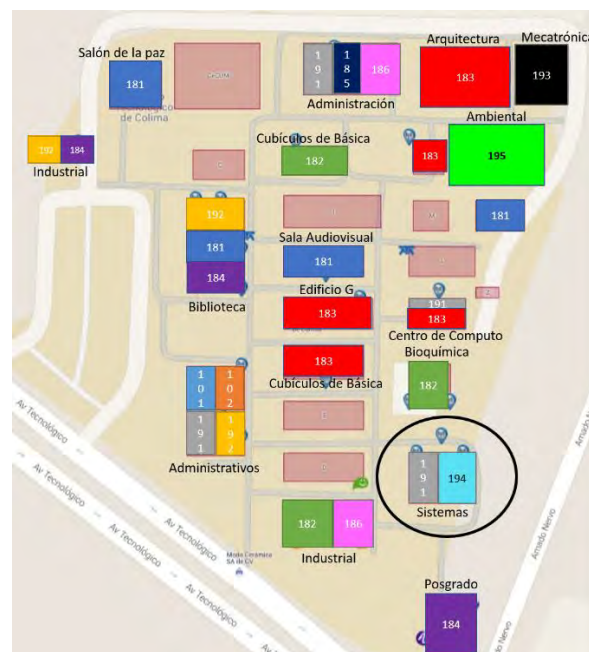
Figura 1. Distribución de VLANs de la red de computadoras del Instituto Tecnológico de Colima
