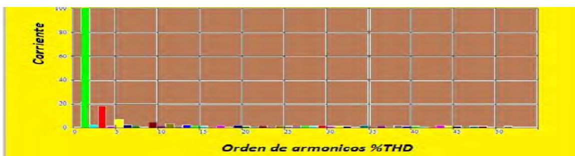
Figura 3. Los armónicos de orden en una carga no lineal.
