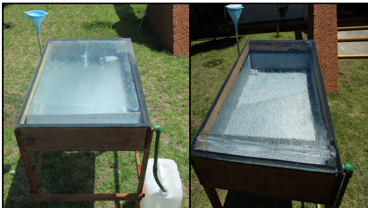
Figura 2. Funcionamiento de prototipo purificador solar de agua. Fuente: Elaboración propia.
